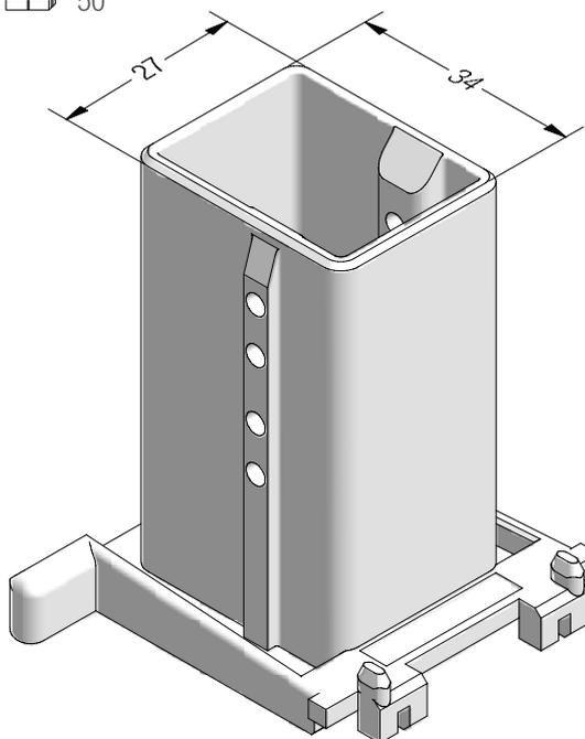
Механический соединитель №1 импоста 86 BT 70
