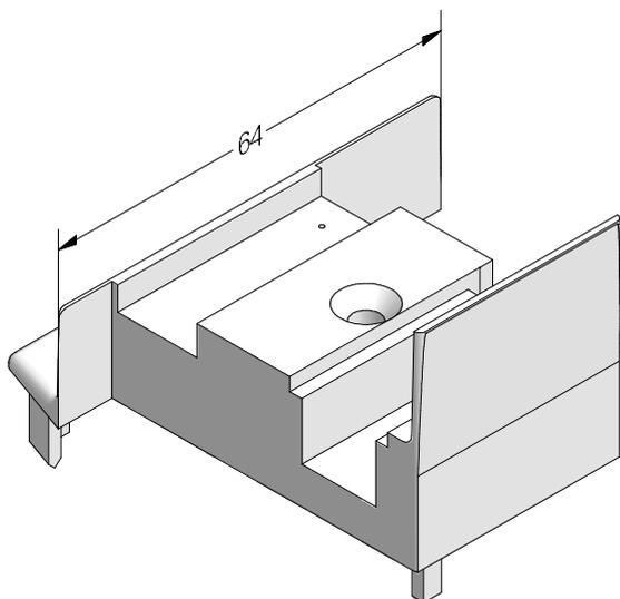
Торцевой колпачок ложного импоста ВТ70
