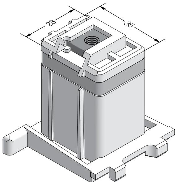
Механический соединитель №2 импоста 86 BT 70
