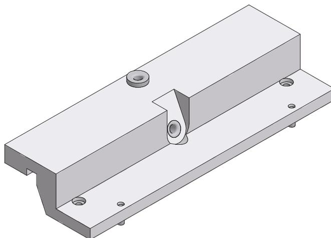
Шаблон для сверления отверстий вентиляции предкамер
